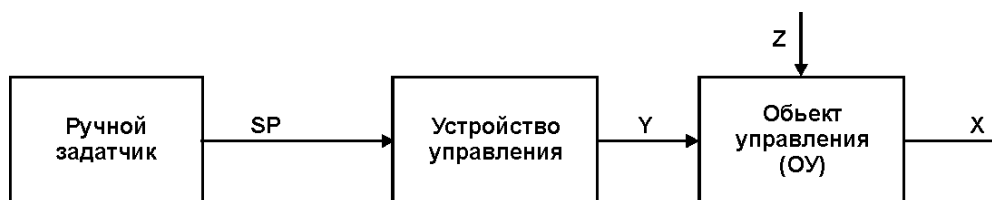
Рисунок 1.2 - Структурная схема разомкнутой системы регулирования
