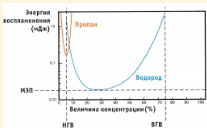
Рис. 1. Характеристики воспламенения для водорода и пропана
