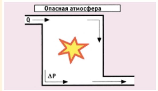
Рис. 4. Схема оболочки, находящейся под повышенным давлением
