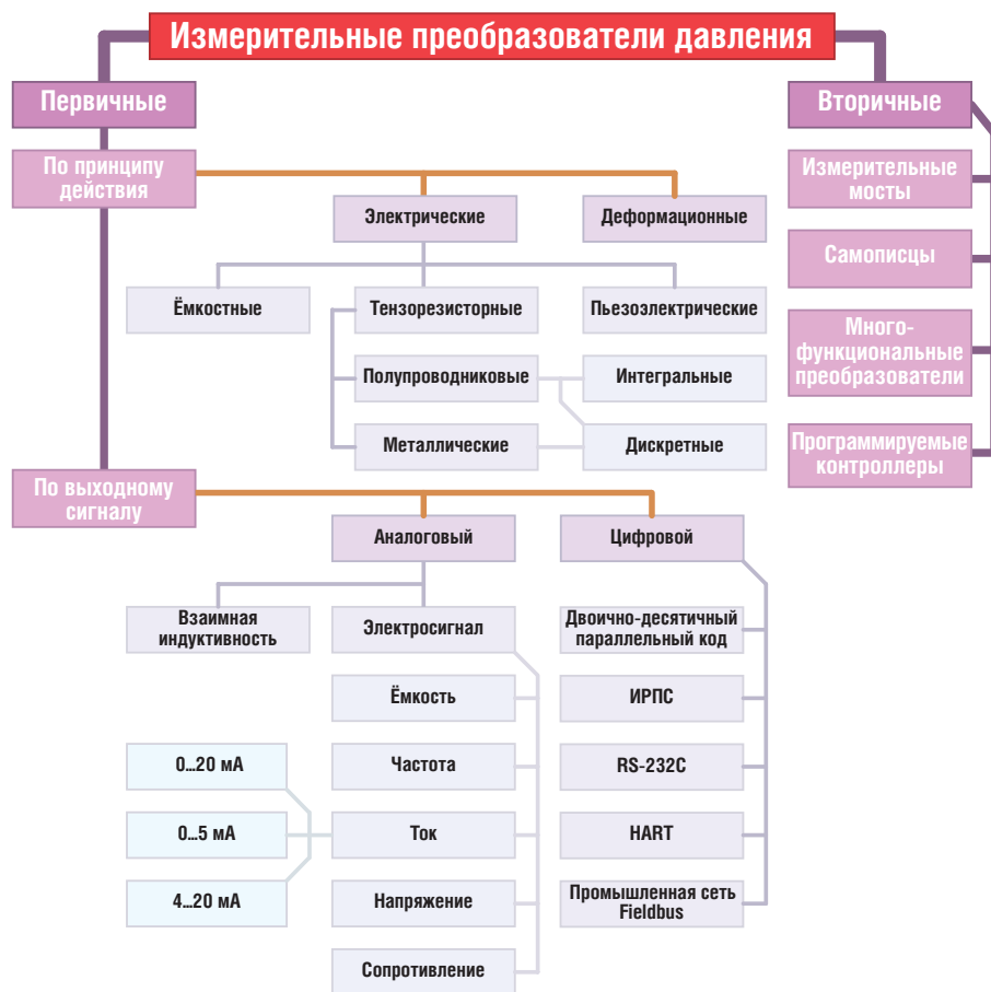
Рис. 4. Классификация измерительных преобразователей давления
