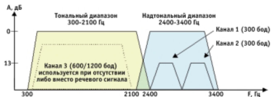
Рис. 5. Организация каналов передачи 300, 300, 600/1200 бод в спектре 300-3400 Гц
