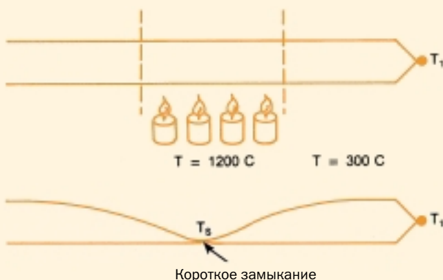
Рис. 18. Локальный нагрев термопары и изменение сопротивления
