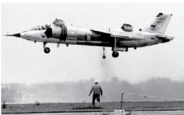
Западногерманский СВВП с комбинированной силовой установкой VAK-191B - несостоявшийся конкурент «Харриера» и «Яка» - на летных испытаниях
