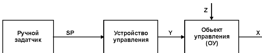
Рисунок 1.2 - Структурная схема разомкнутой системы регулирования
