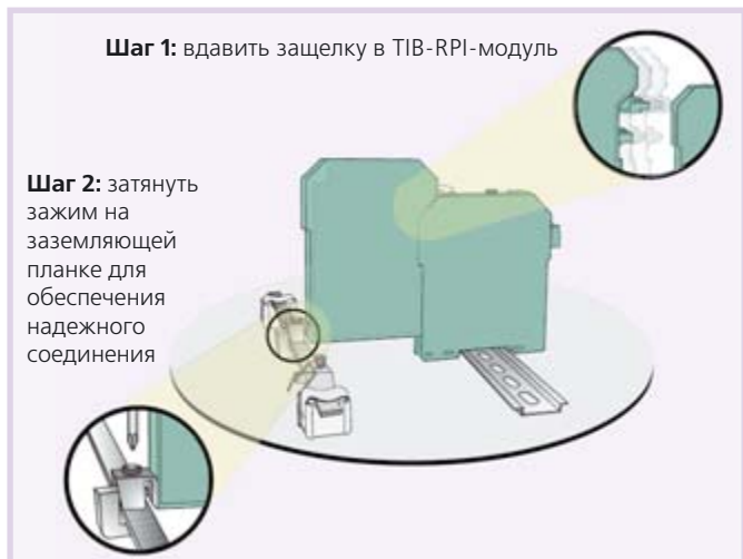
Рис. 9. Технология Snap-On: защёлкивание защитного модуля на передней панели установленного на DIN-рейке модуля К-системы
