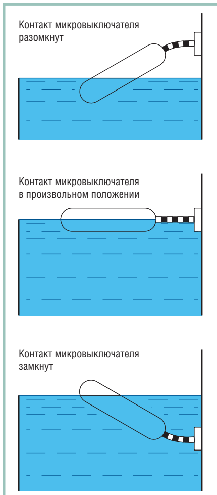
Рис. 1. Принцип действия поплавкового выключателя
