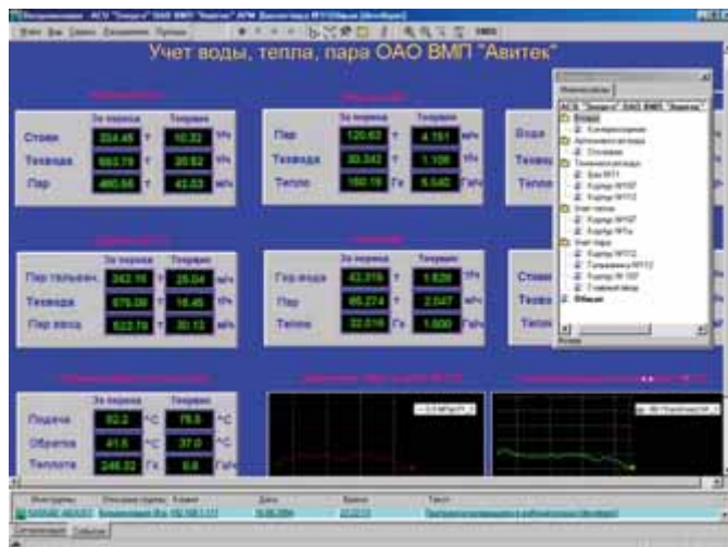
Рис. 3. Копия экрана, отражающая результаты глобального учёта воды, тепла и пара на предприятии
