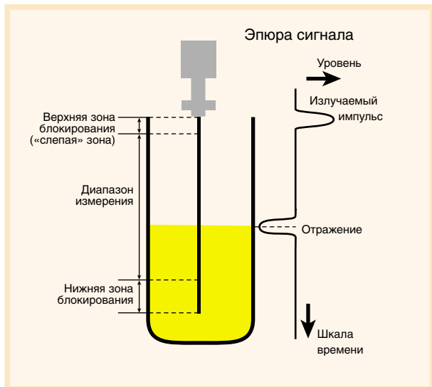
Рис. 11. Принципы измерения методом направленного электромагнитного излучения
