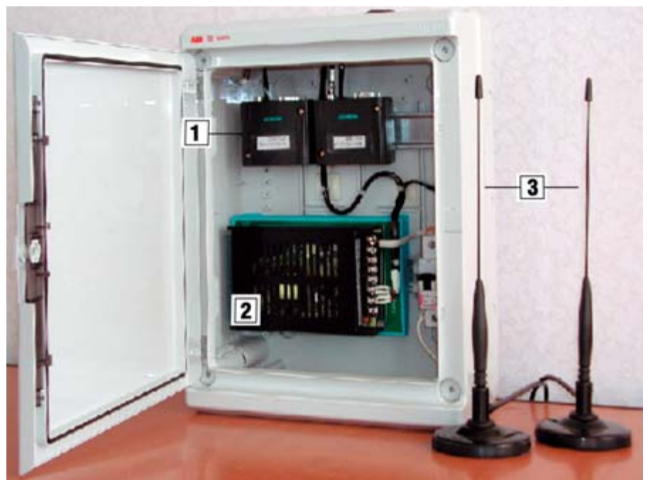
Условные обозначения: 1 — модемы сотовой связи TC35 Terminal; 2 — блок питания PWR-242; 3 — антенны АММ-590.
