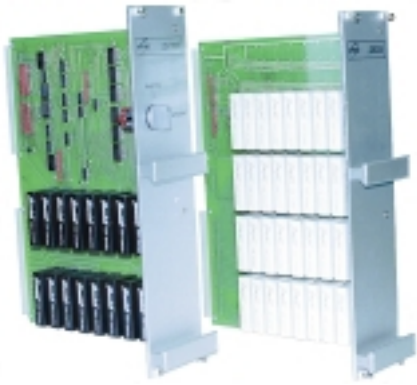
Рис. 6. УСО ввода-вывода дискретных сигналов
