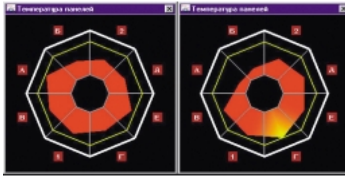
Рис. 9. Распределение температур в топке котла Е-820 при различных регулировках (справа технологически неприемлемый переко́с факела)
